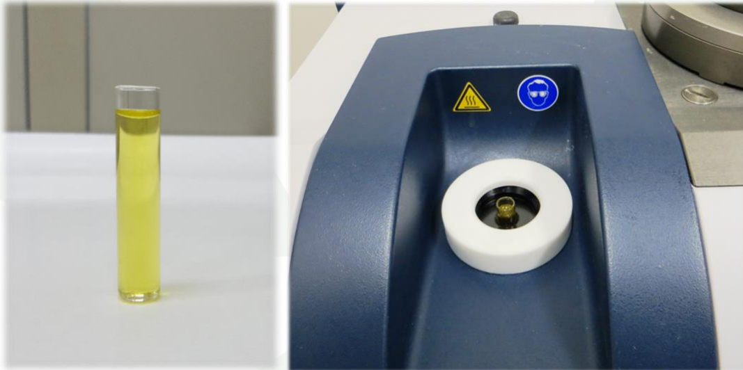
Figura 3. Preparazione dei campioni di olio vergine di oliva da analizzare all'FT-NIR – MPA della Bruker Optics.
